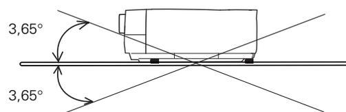
L'angle de projection peut être réglé de 3,65 degrés vers le haut et de 3,65 degrés vers le bas au maximum, en réglant les pieds avant et arrière.
