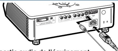
Utilisez le câble audio pour connecter la borne de sortie audio de l'équipement vidéo à la borne d'entrée audio de l'équipement audio.
